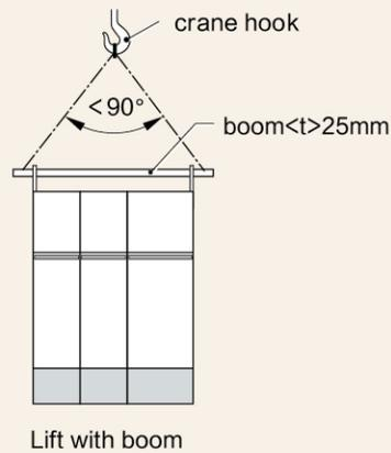
Boom  $\geq 25\text{mm}$
